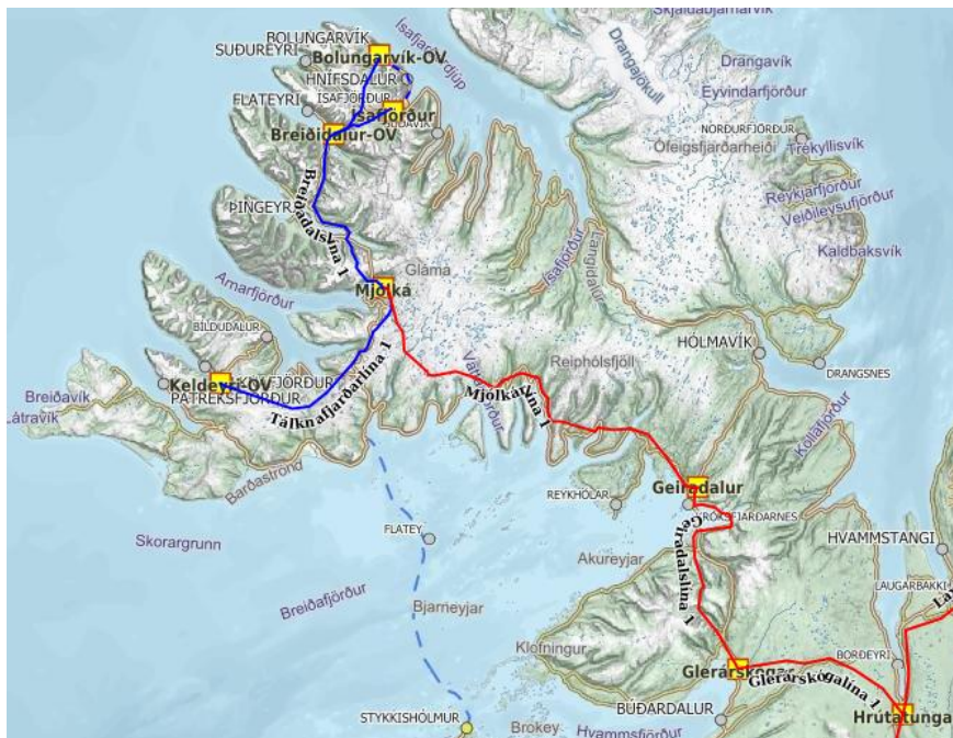
Mynd 2. Flutningskerfi Landsnets á Vestfjörðum. (Landsnet, e.d.).
